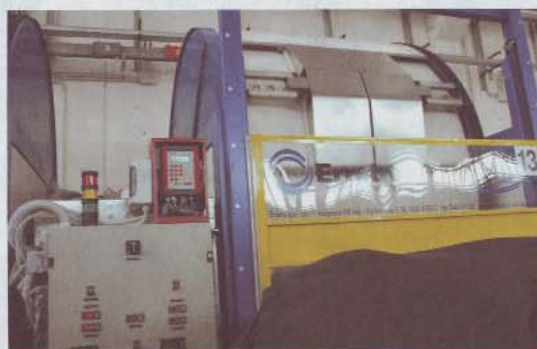
Una botte di follonaggio: la pelle viene ammorbidita tramite lo scuotimento meccanico all'interno di bottali nei quali viene anche regolata l'umidità. Ogni macchina è dotata di un terminale che fa da interfaccia tra la macchina stessa e il sistema gestionale
