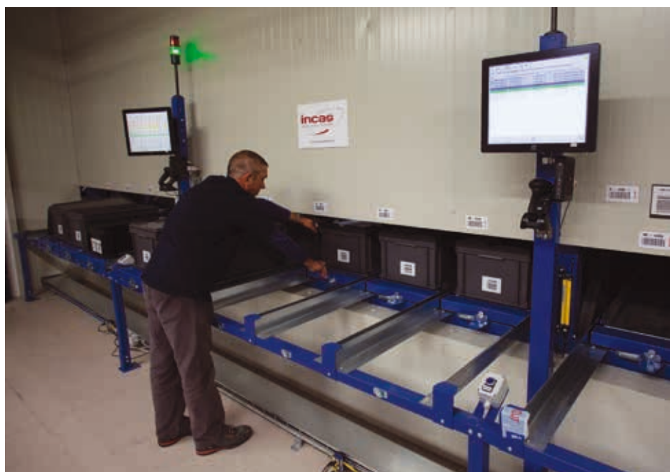
Magazzino automatico asservimento produzione
