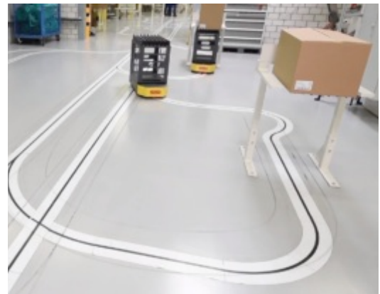
Movimentazione interna gestita tramite AGV e coordinata con le esigenze di produzione ed evasione ordini
